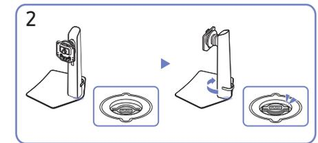
Ruotare il collo del piedistallo in senso orario per fissarlo alla base.
