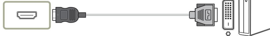
La funzione audio non è supportata se il dispositivo sorgente è collegato utilizzando un cavo HDMI-DVI.
